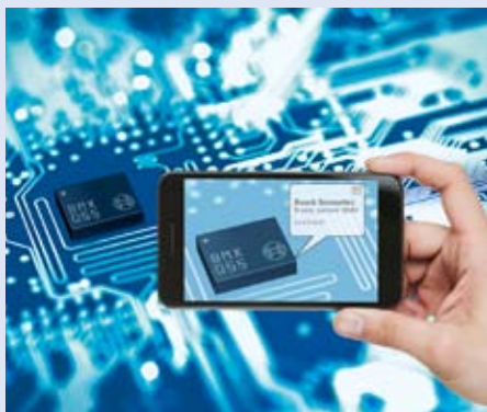
Bosch Sensortec: absoluter Orientierungssensor BMX055 ist Beschleunigungssensor, Gyroskop und geomagnetischer Sensor in einem Gehäuse
