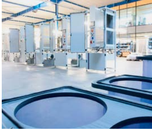
DAS Environmental: Blick in die Fertigung von Abgasentsorgungsanlagen, deren Technologie u. a. in der Halbleiterindustrie eingesetzt wird.
