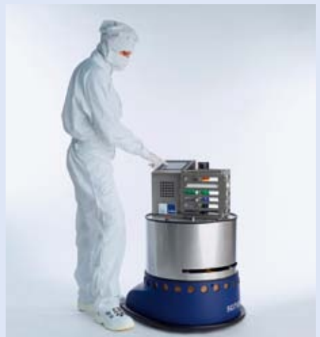
Roth & Rau-Ortner: mobiler Roboter für den Einsatz im Reinraum
