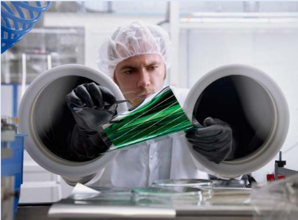
Heliatek: optische Inspektion von flexiblen Modulen
