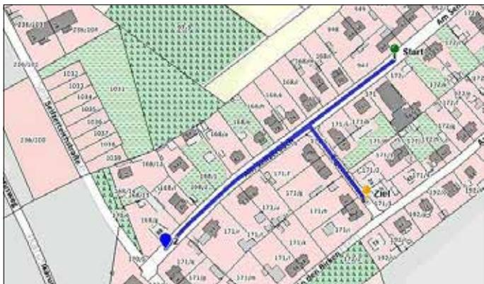
Die Regenwasserkanalisation und die Schmutzwasserkanalisation werden durch die SEDD erneuert und parallel verlegt. Im Rahmen der Baumaßnahme sind die Anschlusskanäle für Grundstücke und Straßeneinläufe neu zu errichten. Die betroffenen Anwohner wurden durch die SEDD direkt informiert.
