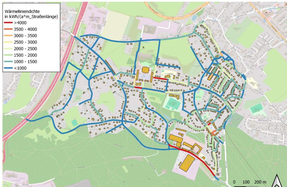
© TU Dresden – Kartendarstellung der Wärmeliniendichten in der Einheit kWh/(a·m)
