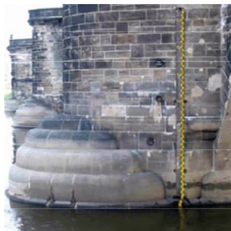
Abb. 6.2.1: Pegel Dresden an der Augustusbrücke, links: Pegellatte, rechts: Anzeige des Wasserstandes auf dem Theaterkahn (Foto: Umweltamt)
