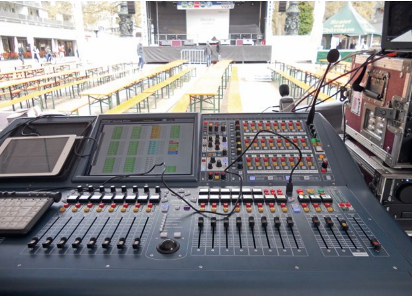
Abb. 7.3.4: Mischpult mit Eigenüberwachung (Foto: Umweltamt)
