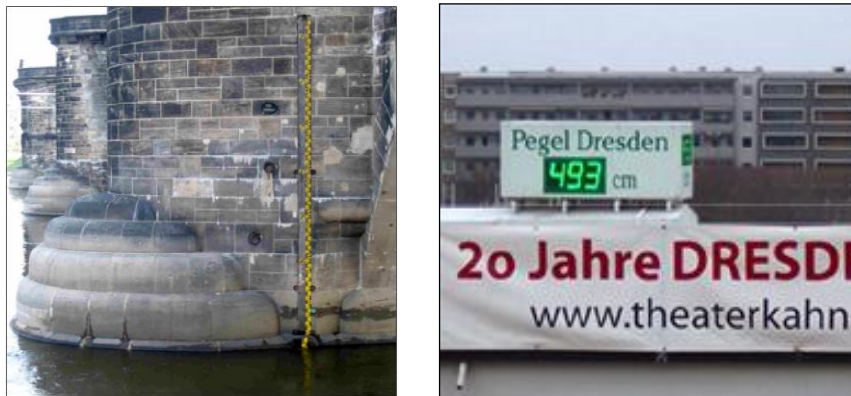
Abb. 5.2.1: Pegel Dresden an der Augustusbrücke, links: Pegellatte, rechts: Anzeige des Pegels auf dem Theaterkahn (©: Umweltamt)
