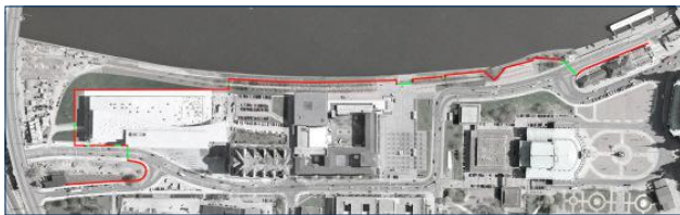
Verlauf der Hochwasserschutzanlage, Bauabschnitt 2, Lose 1 und 2 Grün markiert sind vollmobil zu verschließende Straßenzüge und Wegeföhrungen. Bildquelle: Landeshauptstadt Dresden, Umweltamt, Juni 2008
