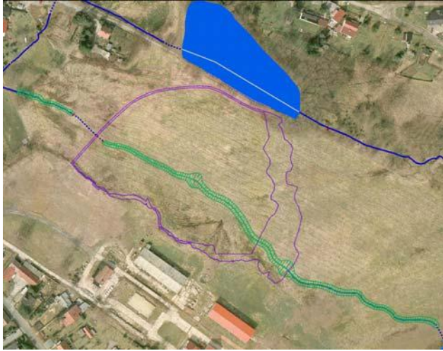
Bild 3: Maßnahme PHD I-016 grün: Gewässeroffenlegung, violett: Damm und Einstaubereich
