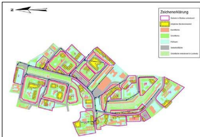
Bild 3: Prinzipdarstellung - Abkopplung von Gebieten von Regenwassernetz, gelb: mögliche Beckenstandorte Bildquelle: Stadtentwässerung Dresden GmbH
