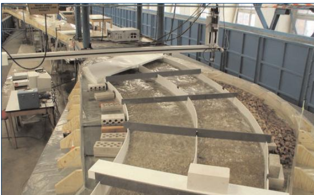
Physikalischer Modellversuch der Flutung des „Weißeritzknicks“ im Maßstab 1:25 an der TU-Dresden Bildquelle: Landeshauptstadt Dresden, Umweltamt, 2007
