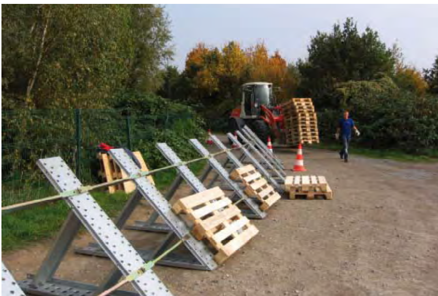
Abb. 5.34: Testaufbau eines Hochwasserschutzsystems auf dem die KA begrenzenden Elbdeich
