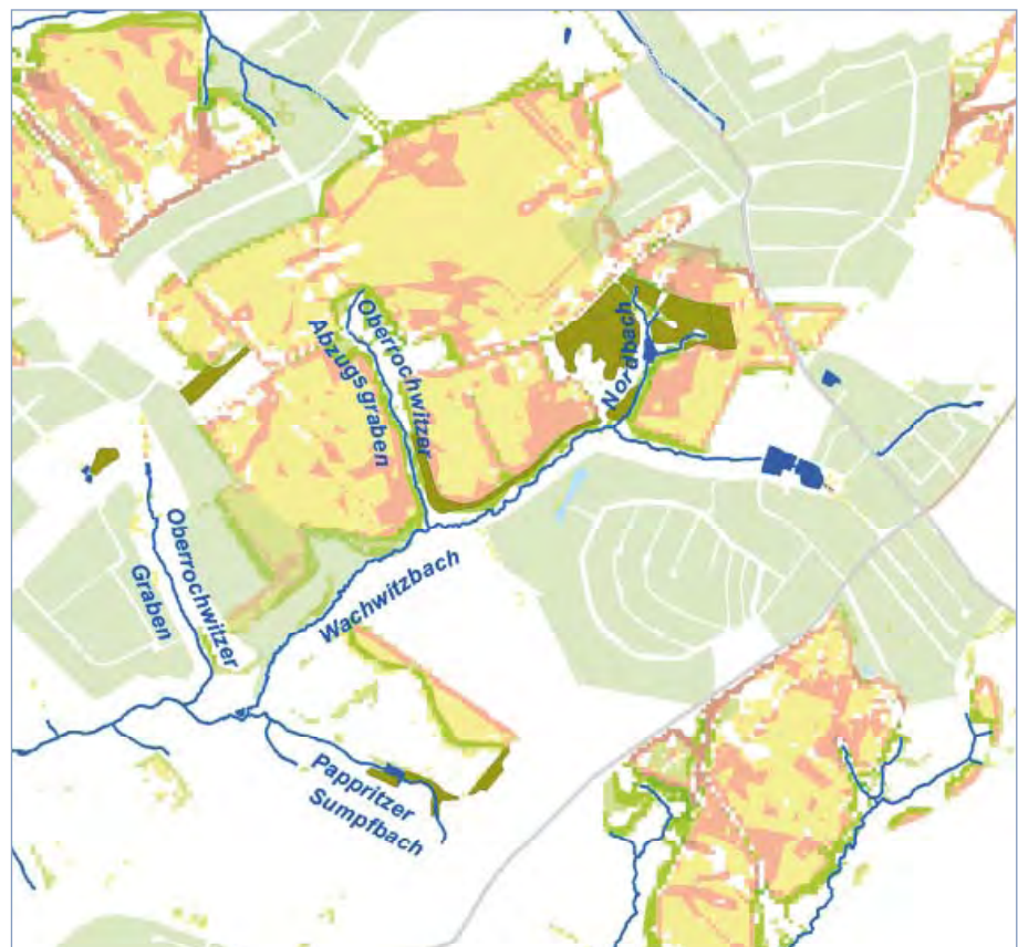
Abb. 4.1: Potenzielle Erosion (gelb, rosa) und Deposition (grün) am Beispiel des Einzugsgebietes des Wachwitzbaches
