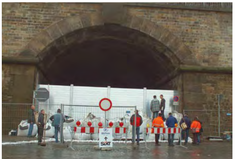
Abb. 5.31: Testaufbau des mobilen Verschlusses in der Brühlschen Gasse ; Bildquelle: Landeshauptstadt Dresden, Umweltamt, 2006.
