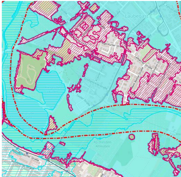
Abbildung 7: Festgesetztes Überschwemmungsgebiet (flächig hellblau) und überschwemmungsgefährdetes Gebiet (schraffiert rot) der Elbe und Abflussbereich (rote Punkt-Strich-Linien) im Bereich Laubegast
