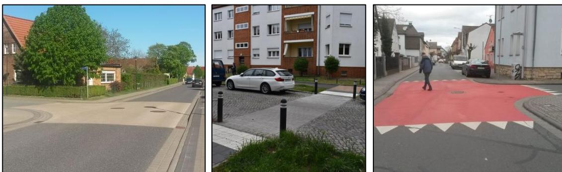
**Abb. 49** Beispiele für farbliche Einfärbung von Knotenpunkten bzw. Querungstellen
