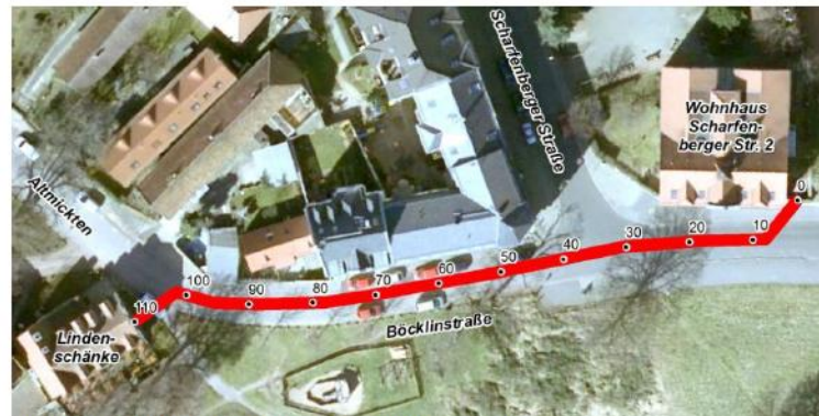
Verlauf Sandsackdamm Altmickten, Zahlenangaben in Meter
