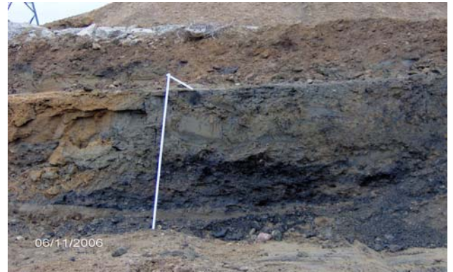
Bild 6: mit Schalöl kontaminierter Boden
