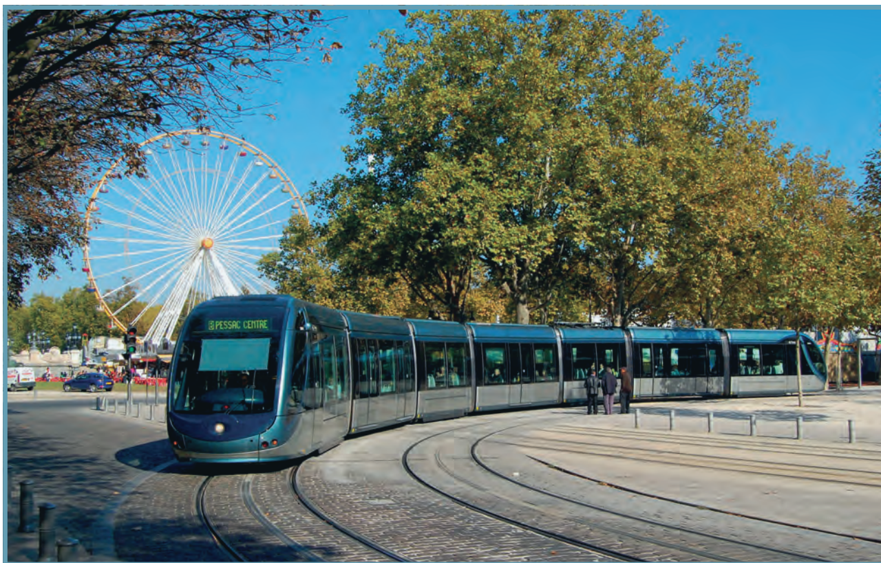
图32：波尔多市阿尔斯通Citadis型有轨电车行驶在无悬线轨道上 41
