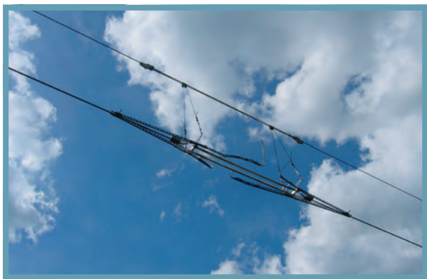
架空电缆断开以切换至不同电力供应系统 13
