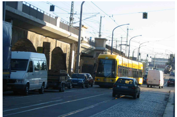
Abbildung 2: Könneritzstraße vor dem Umbau: gegenseitige Behinderungen von ÖPNV und Kfz-Verkehr durch unzureichende Fahrbahnbreiten. Der Pflasterbelag verschlechterte den Fahrkomfort und erhöhte die Umweltauswirkungen.
