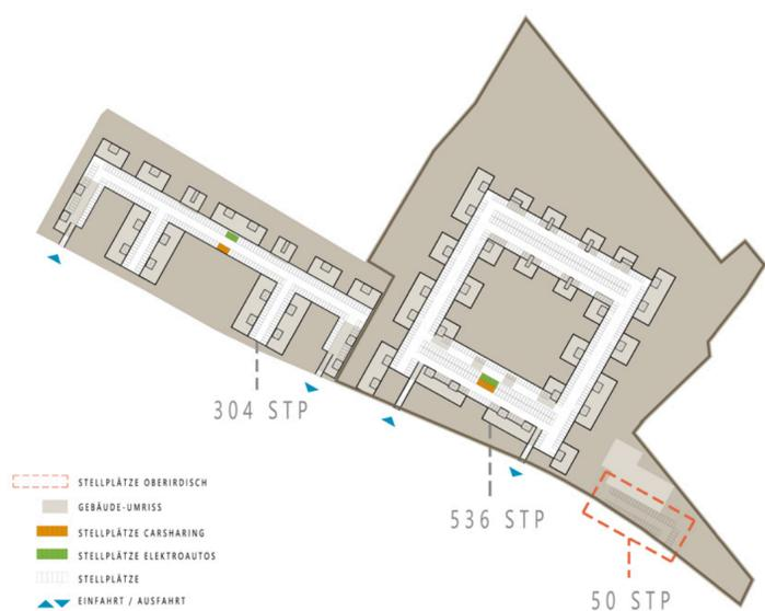
TIEFGARAGE SCHEMATISCHER GRUNDRISS M 1:2000
