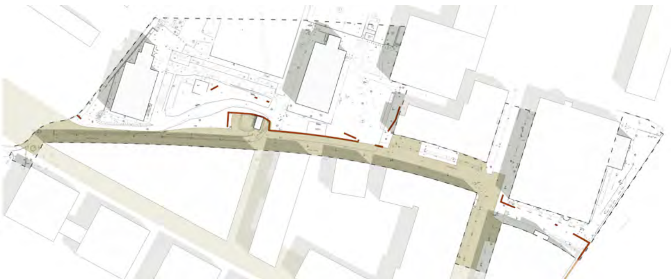
▲ Abb.55 Unterbaute Flächen durch Spundwände, Düker und Nordumfahrung
