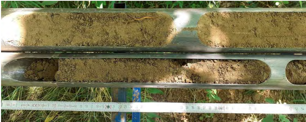
Abbildung 4.1.3: Rammkernsonde am Aufschlusspunkt Bg 17/2022 gewachsener Boden bestehend aus schluffigem Feinsand und Wurzelwerk, Holozän (1,0 – 1,55 m und 2,0 – 2,55 m u GOK).
