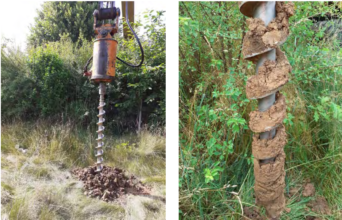
Abbildung 3.2: Abteufen des Sondierbohrlochs mittels Bohrschnecke für Kampfmittelfreigabe am Aufschlusspunkt Bg 11/2022 (links) und 16/2022 (rechts) am 30.06.2022
