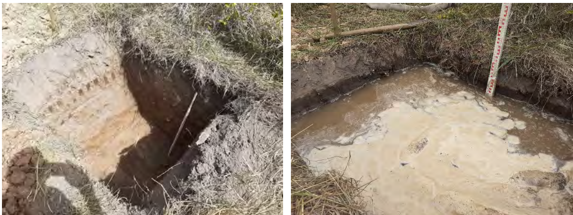
Abbildung 3.5: Schurf 7 vor (links) und während (rechts) des Sickerversuchs am Aufschlusspunkt Bg 07/2022 (13.07.2022).
