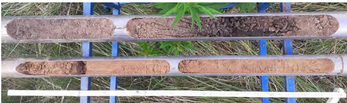
Abbildung 3.3: Erbohrtes Bodenmaterial der RKS 10 (0,0 - 1,0 m u GOK und 1,0 – 2,0 m u GOK) am Aufschlusspunkt Bg 10/2022 (11.07.2022).
