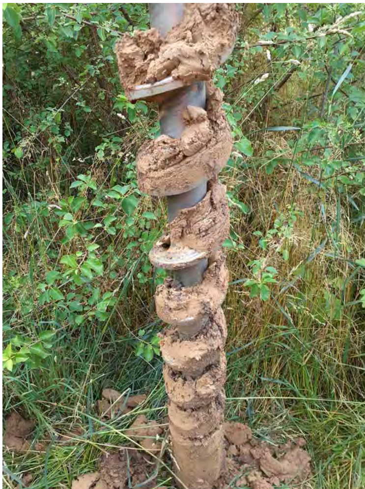
Abbildung 4.1.4: Schneckenbohrung am Aufschlusspunkt Bg 16/2022 mit Bodenmaterial bestehend aus steifen bis halbfesten, feinsandigen Schluff (ca. 4,0 – 5,0 m u GOK).
