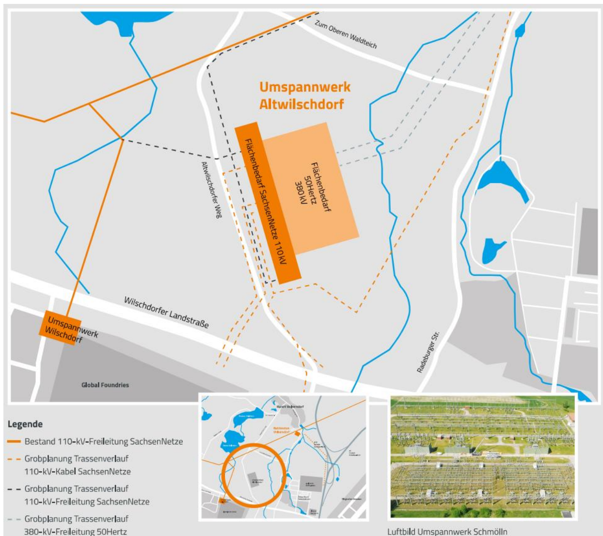
Abbildung 2: Lageplan zu Umspannwerk und Leitungs-/Trassenverläufen am Standort „Altwilschdorfer Weg“ (Quelle: 50Hertz - https://www.50hertz.com )
