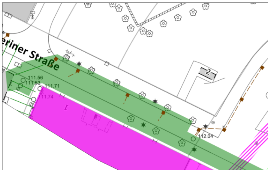
Abbildung 3 - Lage bestehender Rückverankerungen, lagegenau bekannt / lageungenau bekannt
