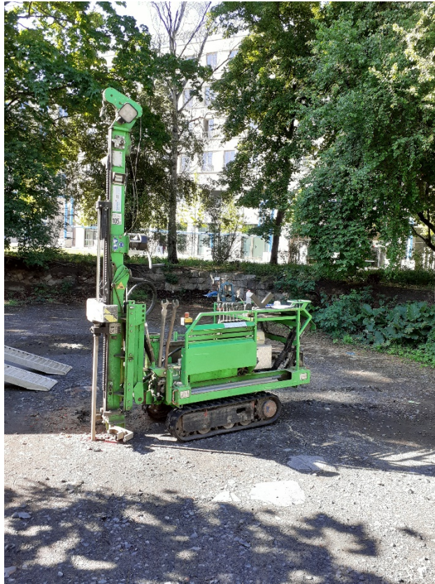
Abbildung 3.2: Schwere Rammsondierung am Aufschlusspunkt Bg 03/2020
