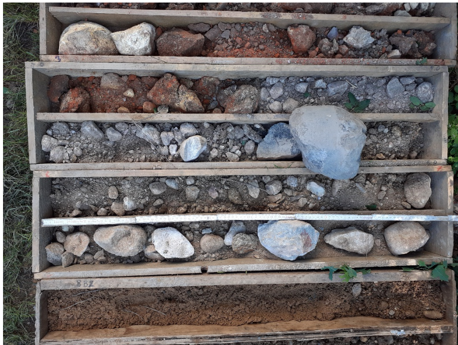
Abbildung 3.4: Kernkisten am Aufschlusspunkt Bg 01/2020 mit Auffüllung (oben), Kiesel- und Gerölle und einer Sandlage (unten), 3 bis 9 m u GOK
