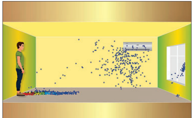
Numerische Simulation zur Berechnung der Ausbreitung von Aerosolen in Innenräumen Foto: HZDR / Michael Voigt
