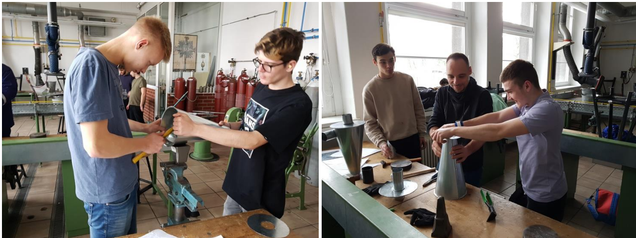
Tätigkeiten zur Herstellung der Zyklone aus Blech (links und rechts)
