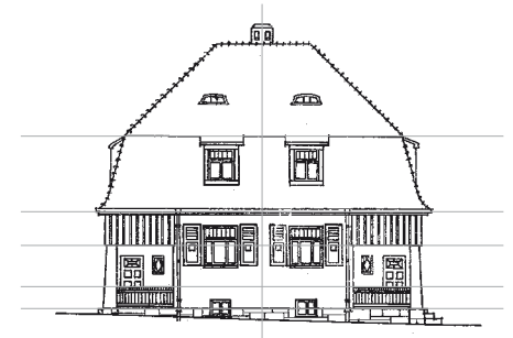
20 Betont horizontale Gliederung, symmetrisches Fassadenbild
