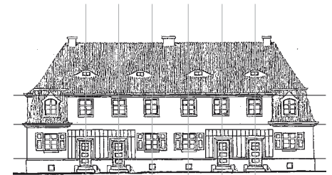
22 Regelmäßige Fensterachsen und horizontale Betonungen
