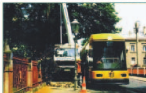
Arbeiten auf engstem Raum in Fahrzeugbreite möglich 2,58 m
