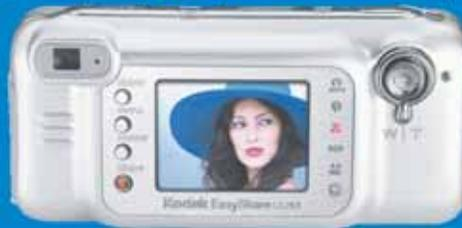
Ausgang (NTSC/PAL), Anschluss für Drucker-Station - Abm. ca. 108 x 49 x 30 mm - Gew. 165 g (ohne Akku). Inkl. Kabel, Li-Ion-Akku, Ladegerät, Softwarepaket.
