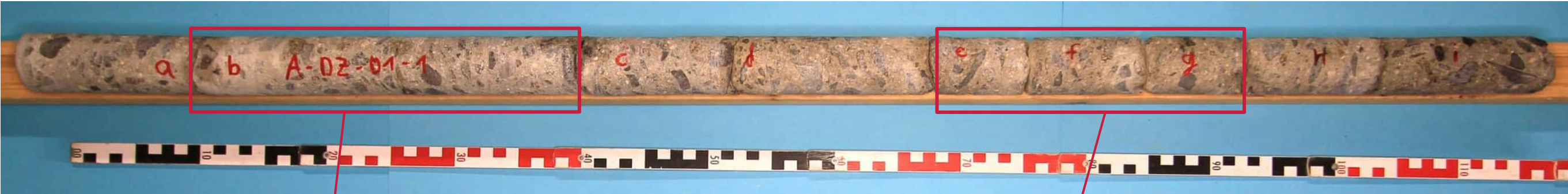
Gefüge des Konstruktionsbetons zwischen 10 und 40 cm Tiefe
