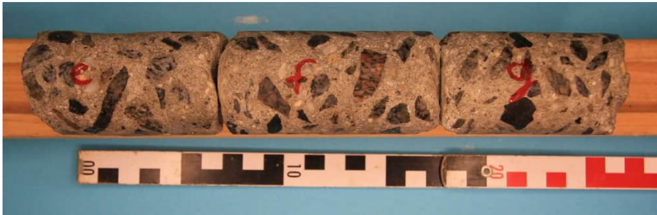
Detail bei ca. 85 cm Tiefe: Bohrkern hat zwischen Stück f und g beim Bohren gerieben → gelöster Verbund
