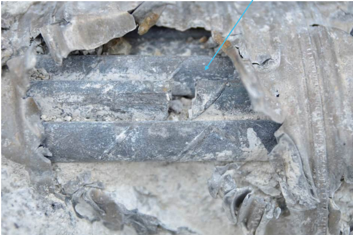
Abbildung 212: Drahtbruch mit Mörtel in der Bruchfläche
