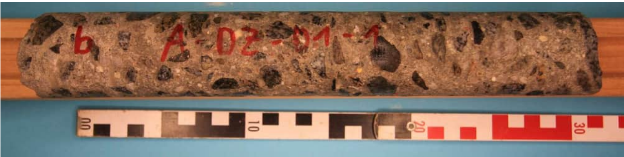
Gefüge des Konstruktionsbetons zwischen 10 und 40 cm Tiefe
