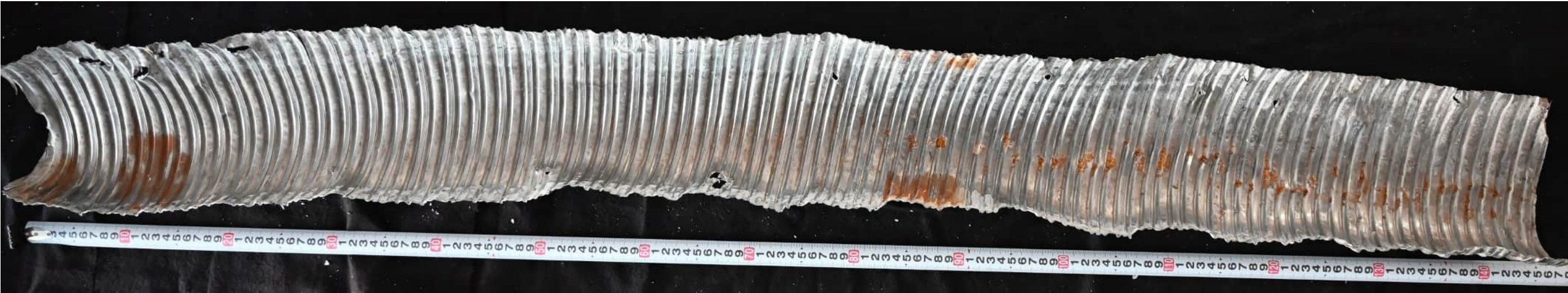
Geöffnetes Hüllrohr: Schnitt entlang 0° Linie:
