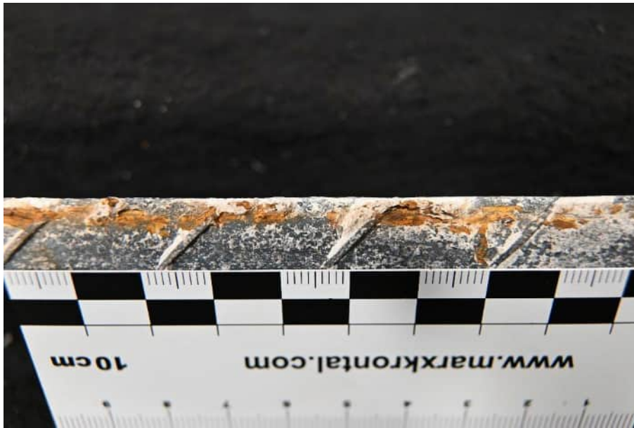
Abbildung 389: Rostspuren am Spanndraht 22
