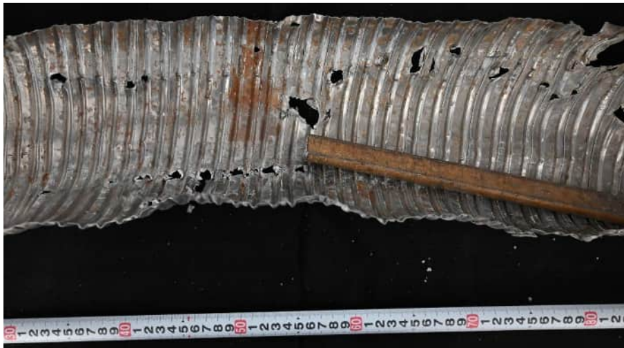
Abbildung 358: Rostspuren an Hüllrohrerseite (innen)
