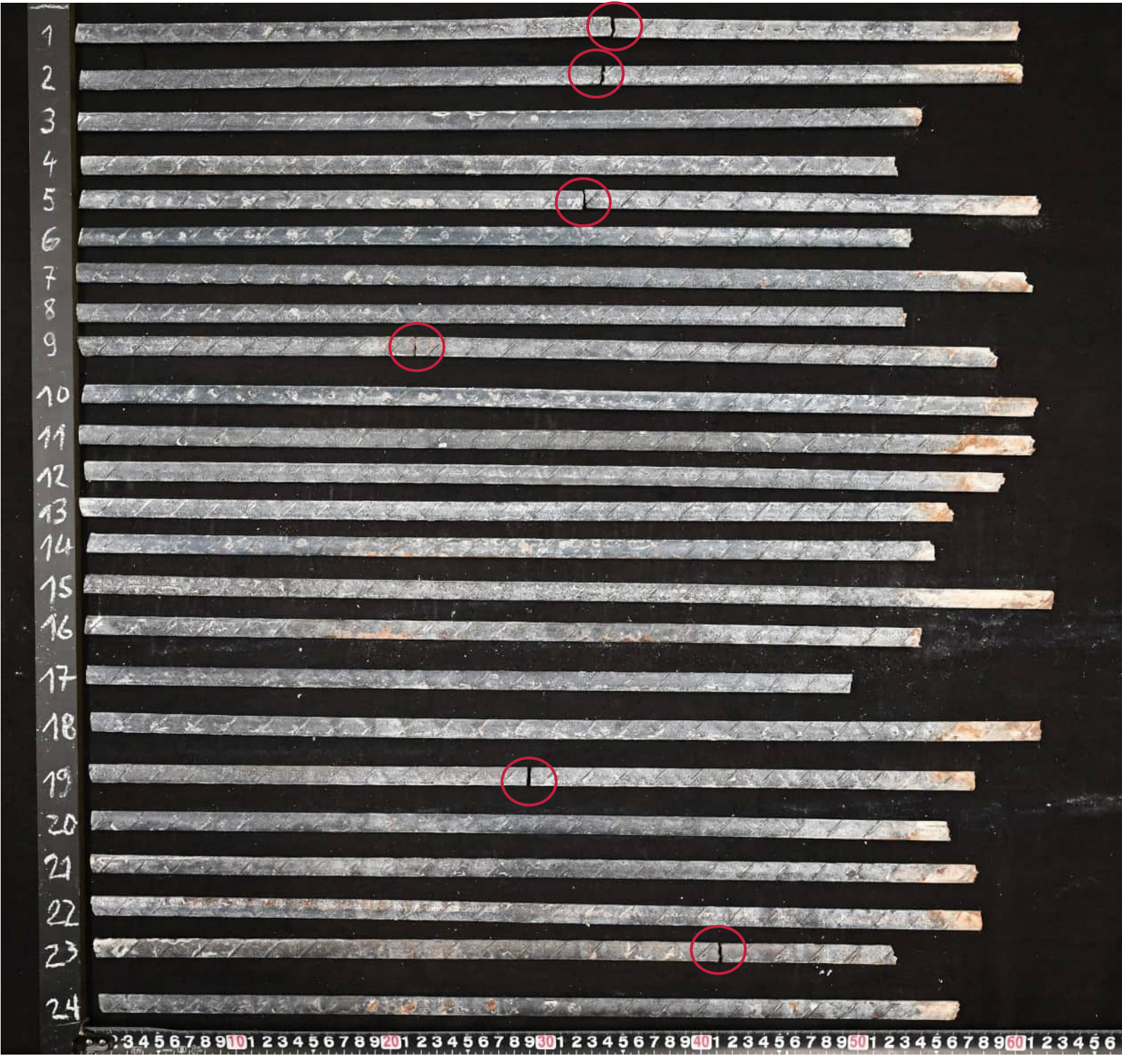
Abbildung 418: Übersicht Drähte, weitere Drahtbrüche im Spannglied (rote Kreise)
