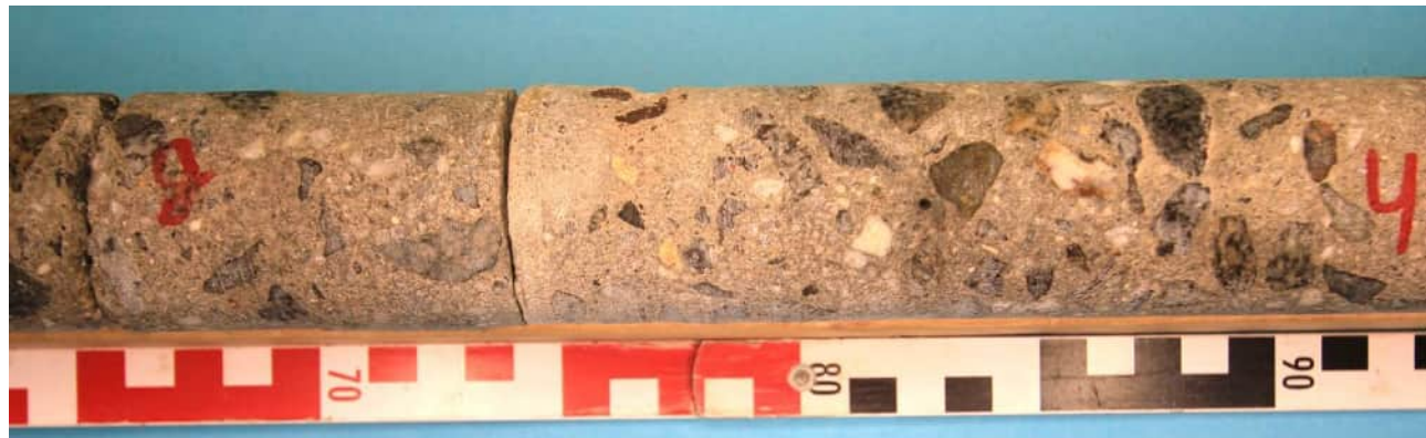
Detail bei ca. 75 cm Tiefe: kein Verbund zwischen Teilstück g und h
