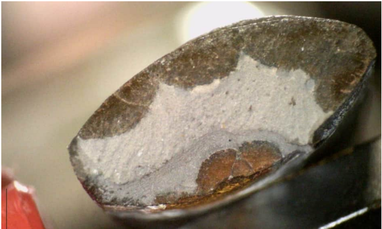
Abbildung 236: Bruchfläche Draht 1-6. Mikroskop
