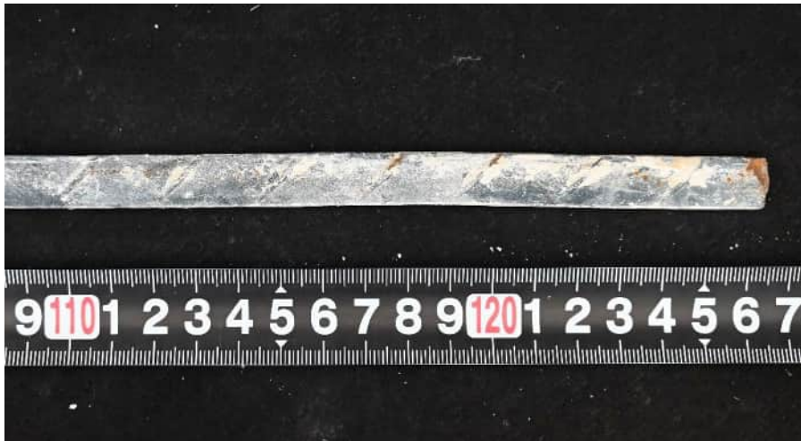
Abbildung 374: Rostspuren am Spanndraht 13
