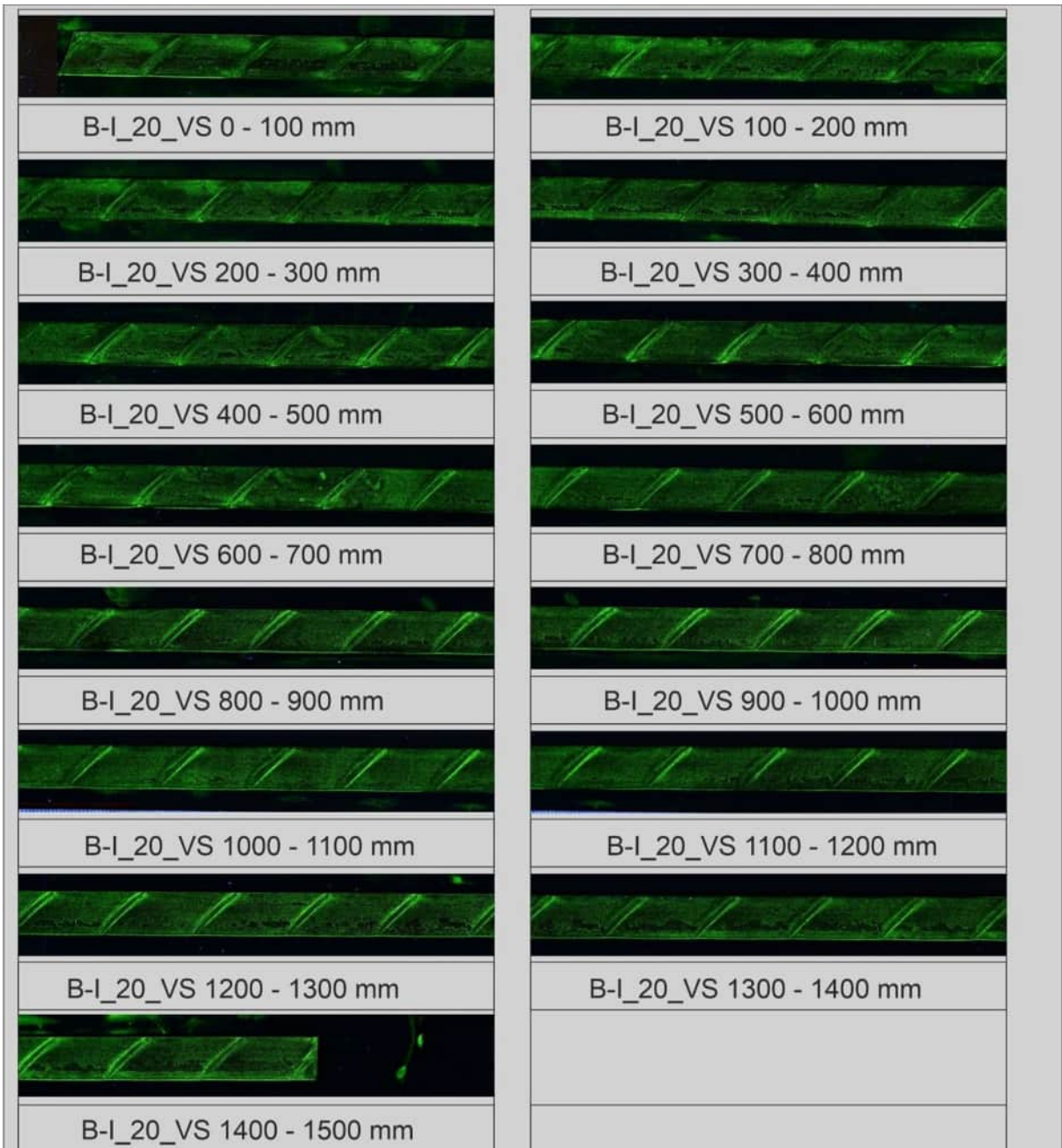
Abbildung 333: Ergebnisse der Anrissprüfung, Draht 20, Quelle: BAM [U10]
