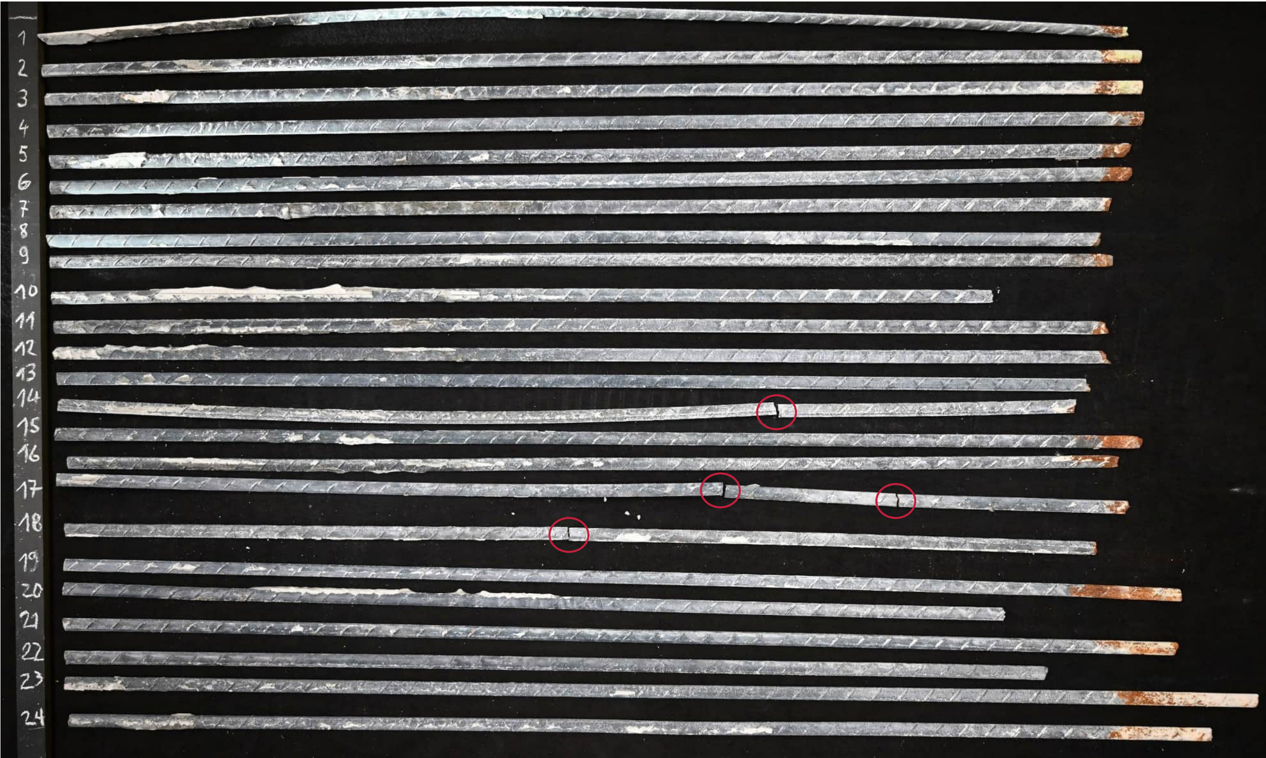
Abbildung 403: Übersicht Drähte, weitere Drahtbrüche im Spannglied (rote Kreise)
