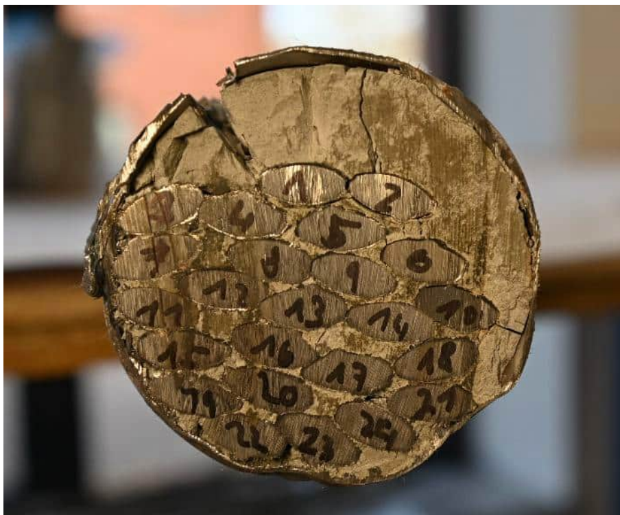
Abbildung 353: Rostspuren am Verpressmörtel
