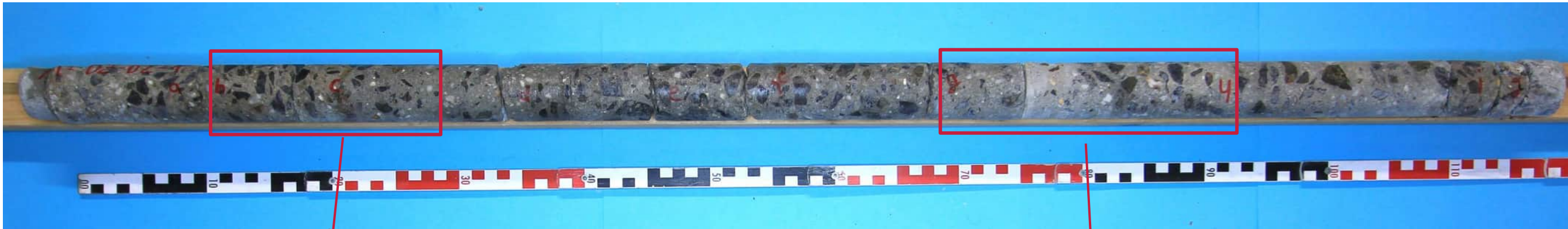
Detail bei ca. 20 cm Tiefe: Übergang zwischen unterschiedlichen Betonierlagen (rote Pfeile)
