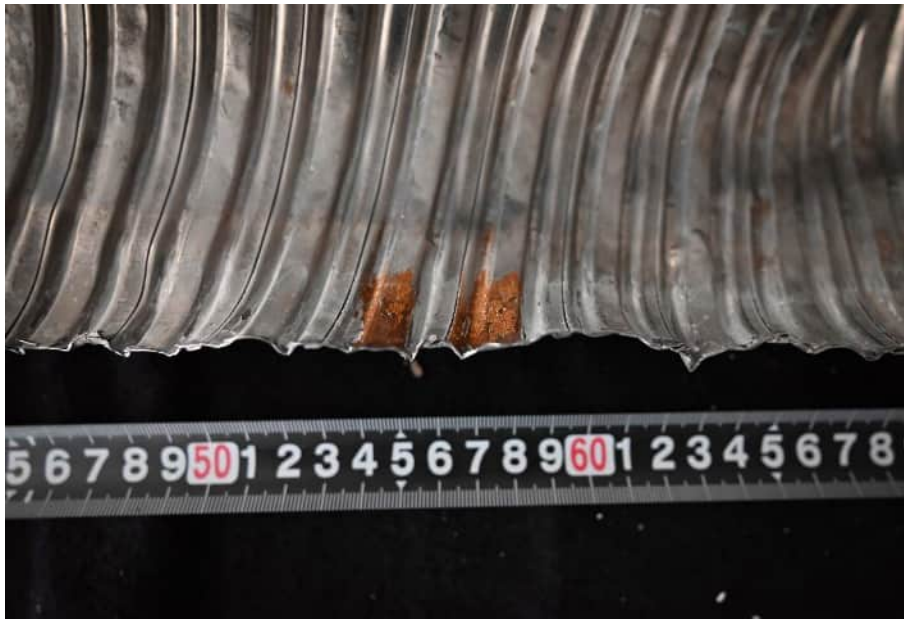
Abbildung 339: Rostspuren an Hüllrohroberseite (innen)
