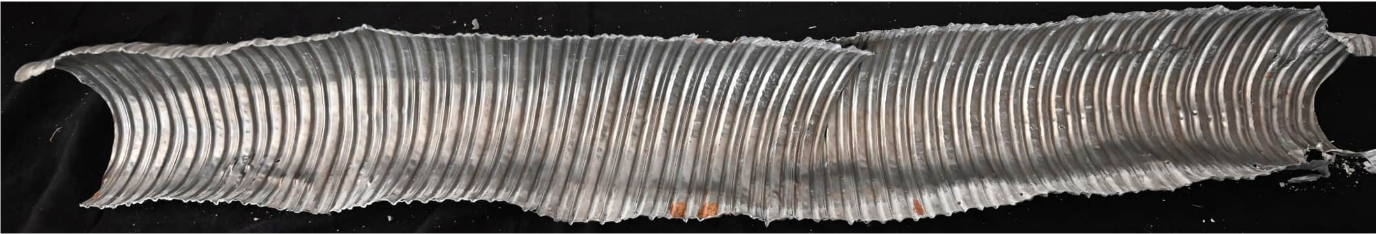
Geöffnetes Hüllrohr: Schnitt entlang 0° Linie:
