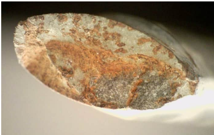
Abbildung 375: Rostspuren an der Bruchstelle (SD 13)
