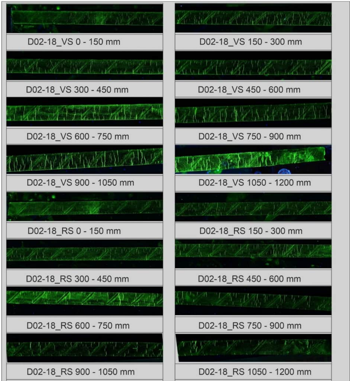
Abbildung 393: Ergebnisse der Anrissprüfung, Draht 18, Quelle: BAM [U10]
