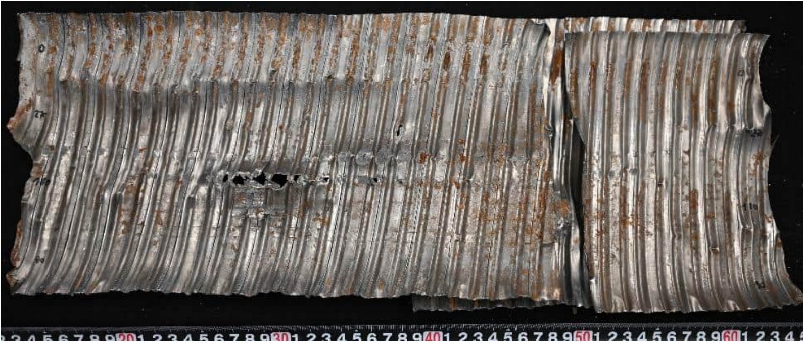
Geöffnetes Hüllrohr: Schnitt entlang 0° Linie:
