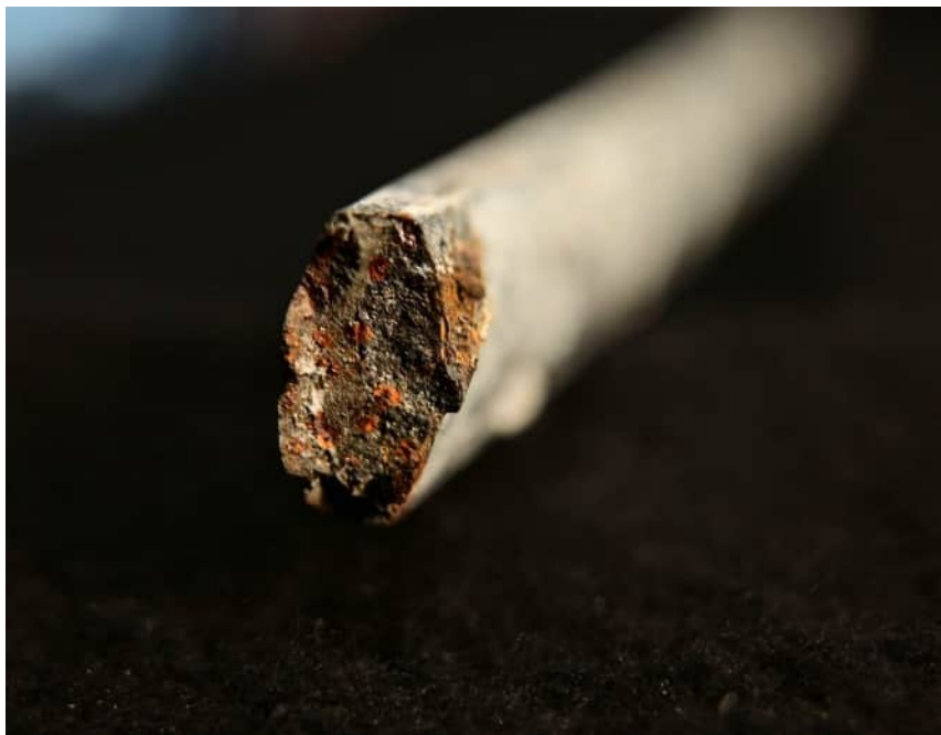
Abbildung 390: Rostspuren an der Bruchfläche (SD22)
