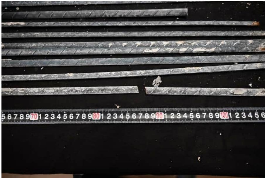
Abbildung 397: Spanndrahtbruch im Spannglied
