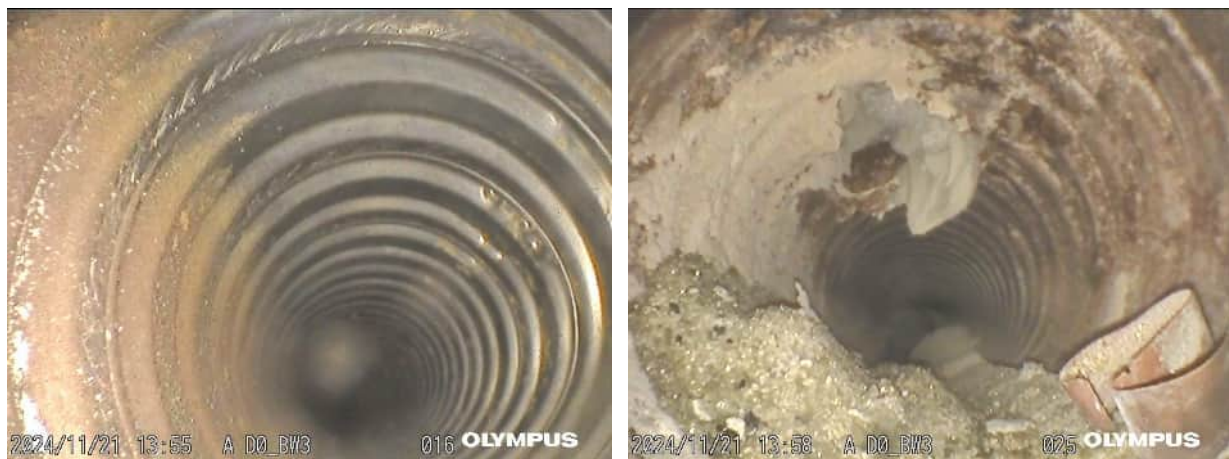
Abbildung 11: Endoskopbefahrung des Bohrkanals: Spuren von zeitweiser Feuchtigkeitsbelastung (links) und Betoneinbruch (rechts)
