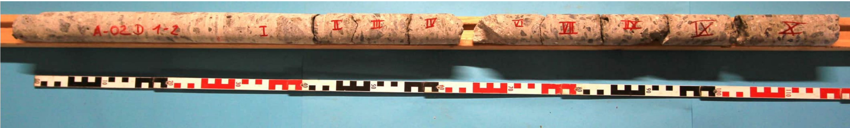
Übersicht Bohrkern: Zerrütteter Beton bei ca. 65 cm Tiefe
