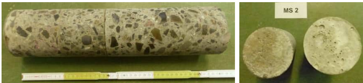
Abbildung 15: Bohrkern nahe der Bodenplatte Zug C in Achse E mit verbundloser Fuge © Saxotest [U14]
