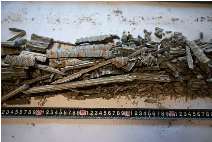
Abbildung 323: Rostspuren am Verpressmörtel
