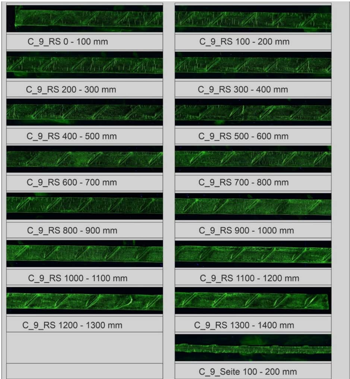
Abbildung 364: Ergebnisse der Anrissprüfung, Draht 9, Quelle: BAM [U10]
