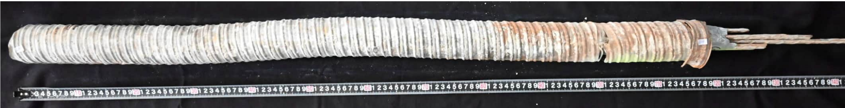
Geöffnetes Hüllrohr: Schnitt entlang 0° Linie:
