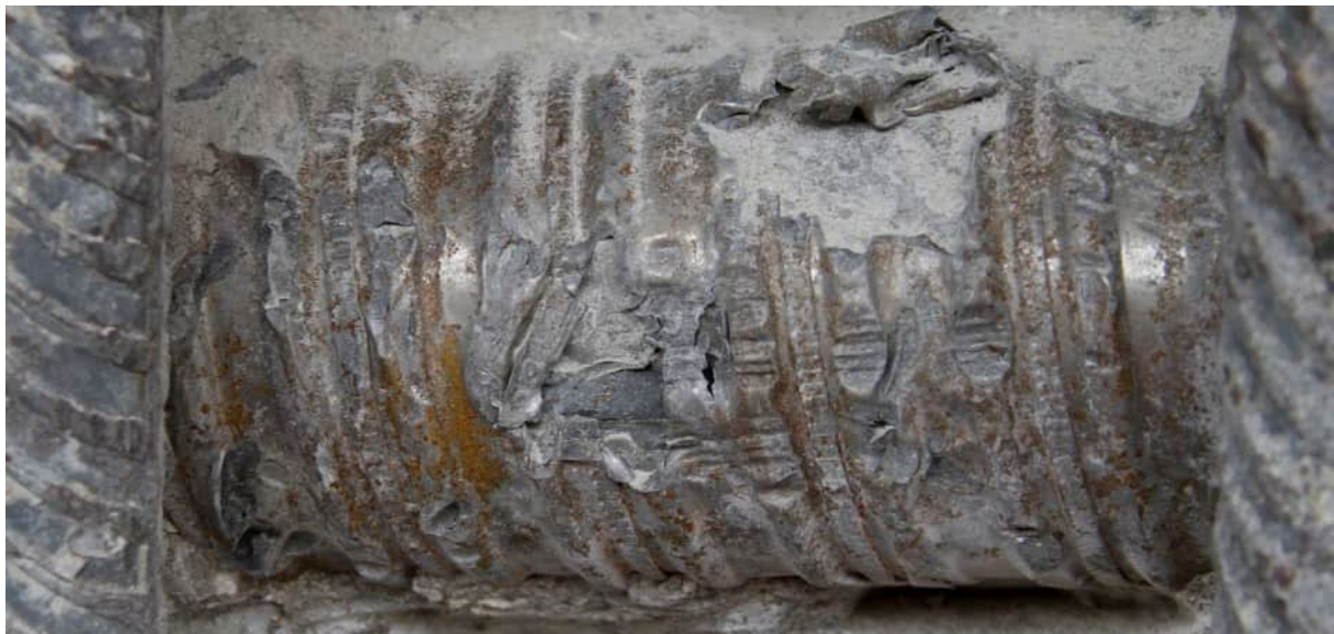
Abbildung 106: Hüllrohrzustand von außen [U14]
