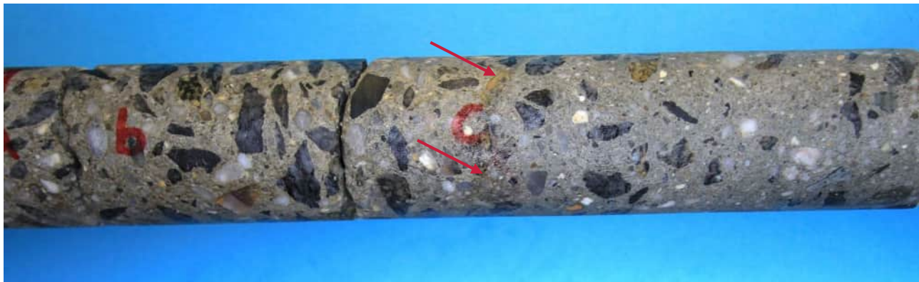
Detail bei ca. 20 cm Tiefe: Übergang zwischen unterschiedlichen Betonierlagen (rote Pfeile)
