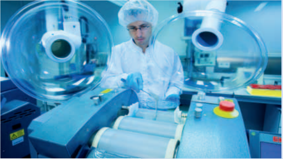
Fraunhofer IKTS: Dickschichtpasten werden zur Kontaktierung von Solarzellen verwendet. Mittels Siebdruckverfahren werden sie auf den Front- und Rückseiten der Solarzellen aufgebracht.
