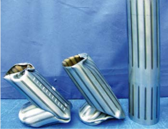
Fraunhofer IWS: lokale Verfestigungszonen zur präzisen Verstärkung von Bauteilen
