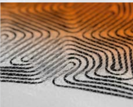
Qpoint Composite-Heizstrukturen bieten eine kostengünstigere Fertigung von Faserverbundbauteilen ohne den Einsatz von großen Industrieöfen oder Autoklaven.
