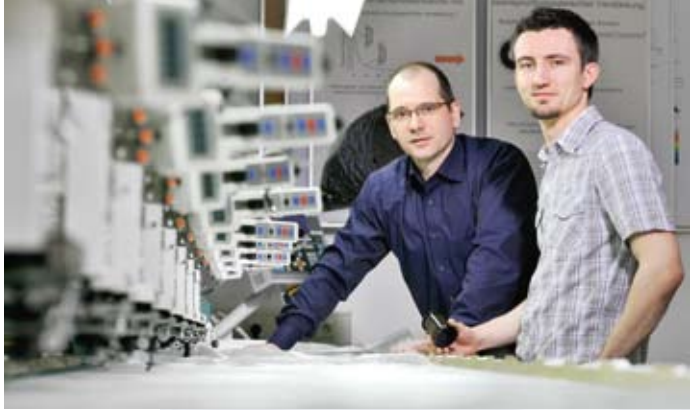
Qpoint Composite GmbH: Fertigung von textilen Heizelementen mit einer Stickmaschine
