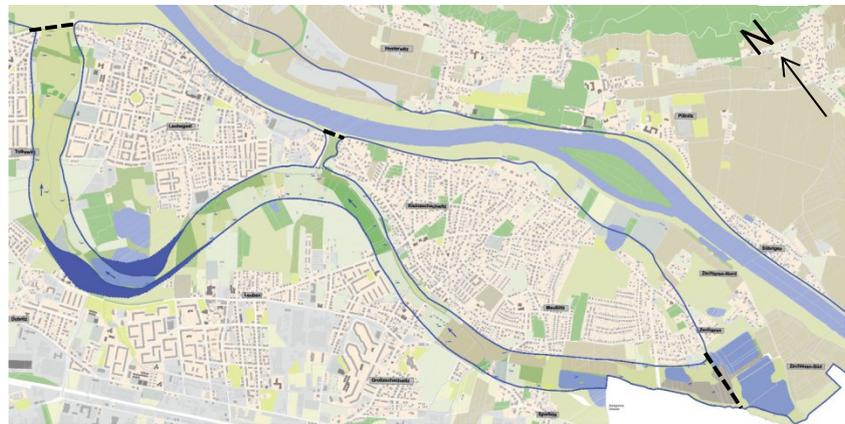
**Abbildung 1: Abflussgebiet der Elbe zwischen Tolkewitz und Zschieren – Vorschlag für weitere Flächen (flächig dunkelblau), die dem geltenden Abflussbereich (von grauer Linie umrandet) zuzuschlagen sind**
