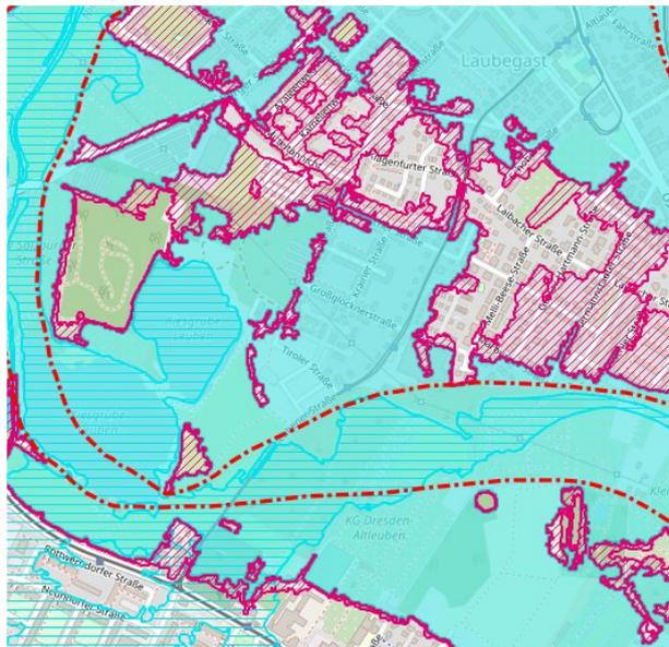
**Abbildung 7: Festgesetztes Überschwemmungsgebiet (flächig hellblau) und überschwemmungsgefährdetes Gebiet (schraffiert rot) der Elbe und Abflussbereich (rote Punkt-Strich-Linien) im Bereich Laubegast**
