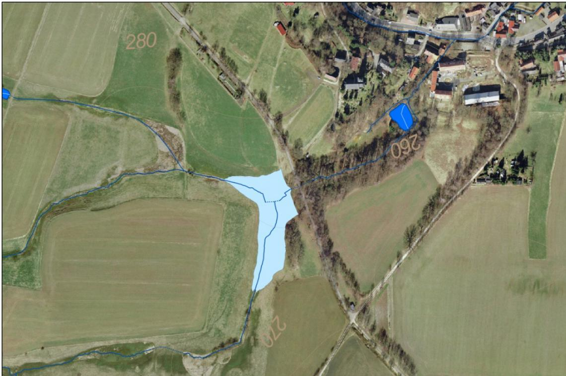
Abbildung 45: Maßnahme I-275 – HWRB am Alten Bahndamm, Einstaufläche für Becken Variante 1,  $V = 12.000 \text{ m}^3$  (Quelle: U 1)
