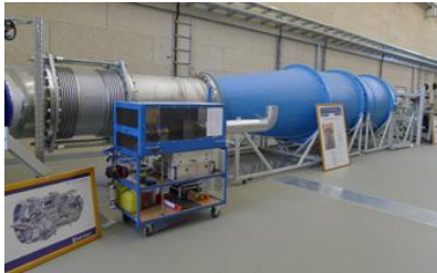
Herzstück des neuen Forschungsgebäudes des Zentrums für Energietechnik an der TU Dresden ist eine 600-Kilowatt-Gasturbine. Foto: Ruhna
