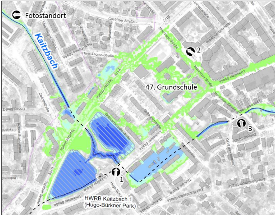
Bild 4.24 Simulierte maximalen Wasserstände am HWRB Kaitzbach 1 (Hugo-Bürkner-Park) für das Ereignis am 27.05.2014
