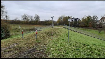
Abb. 2: Digitaler Wasserstandsmesspegel (hier Solarpaneel, Kamera, Datenlogger) im HRB Nöthnitzbach, 11.11.2020
