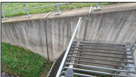
Abb. 1: Drucksonden des digitalen Wasserstandsmesspegels B<sub>2</sub>W021 im HRB Nöthnitzbach, 11.11.2020
