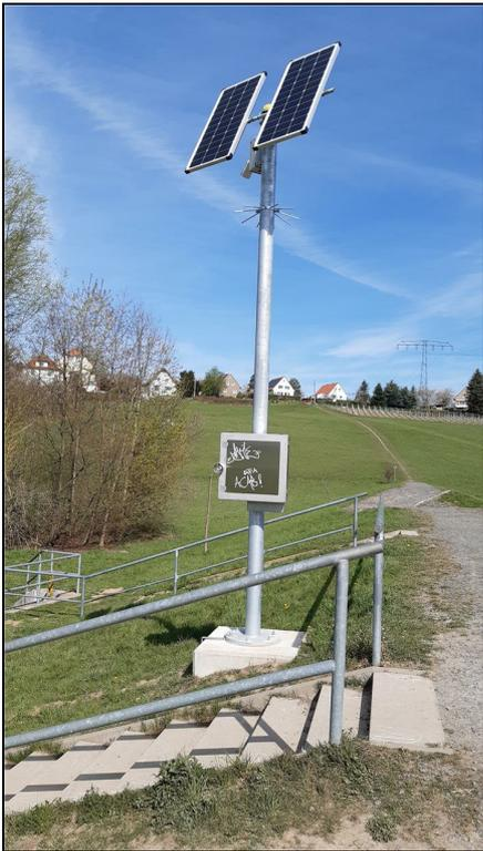
Abb. 2: Solarpaneel, Kamera und Datenlogger des BÜW017 im HRB Kaitzbach 2), 16.04.2020
