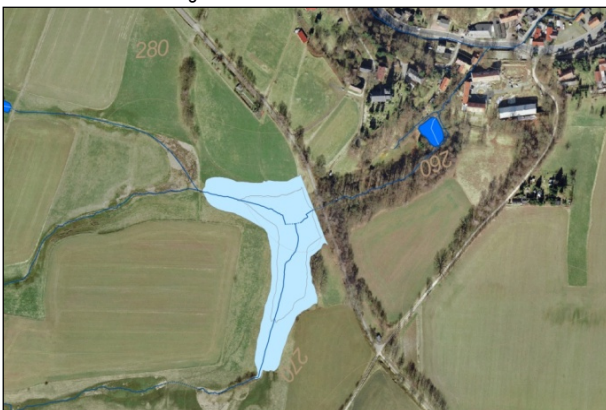
Bild 4: I-275 Eintauchfläche Hochwasserrückhaltebecken (Speichervolumen ca. 51.000 m 3 )
