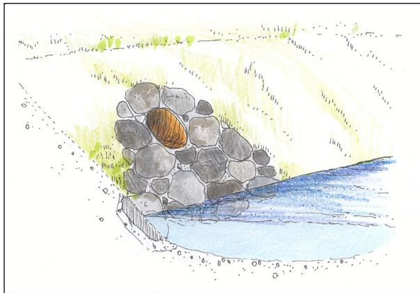
Gewässer mit flachen Ufern (Neigung 1:2 und flacher) sind ebenfalls gegen Ausspülung zu sichern. Hier ist eine Befestigung mit einem in Kiessand gebetteten Steinsatz unterhalb der Rohrausmündung ausreichend.
